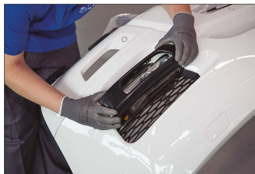
02 › Montaje de los accesorios en el paragolpes (rejilla inferior, antinieblas...)
