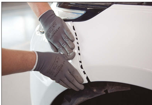
05 | › Montaje de la zona lateral izquierda y derecha del paragolpes
