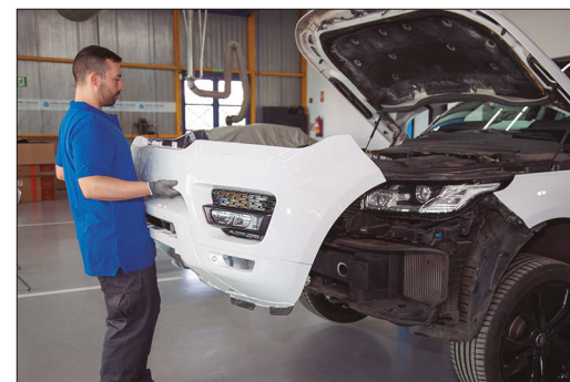
03 › Montaje del paragolpes en el vehículo y acople de las conexiones eléctricas
